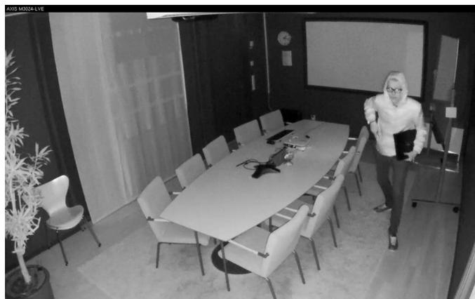
Le immagini sopra riportate di una telecamera AXIS M3024-LVE riprendono la stessa scena di un uomo con una piccola torcia elettrica all'interno di una stanza buia e mostrano la differenza che risulta dall'impiego dell'illuminazione IR per la sorveglianza in ambienti bui. La luce IR è invisibile all'occhio umano, ma è visibile alla telecamera.
